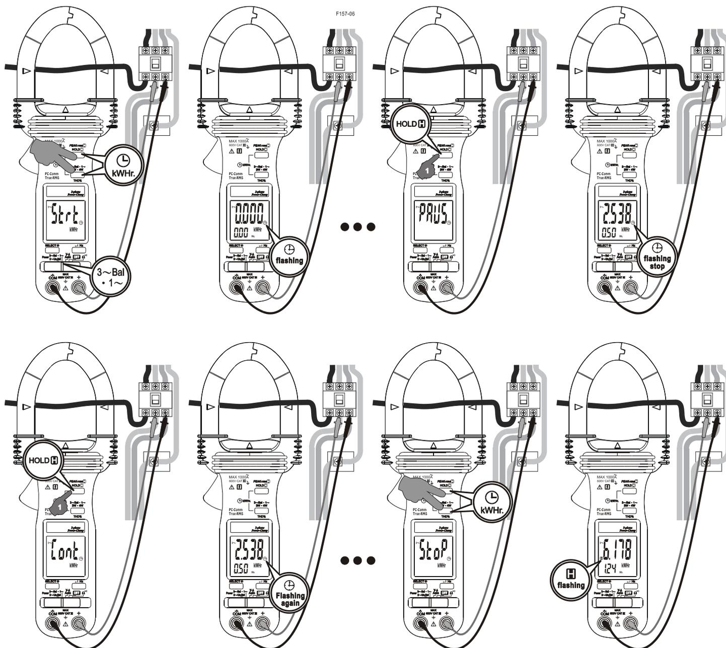
Posicione a chave seletora de função em “3~Bal . 1~”. Configure as medições de potência como mencionado na seção anterior “Função Potência Monofásica & Trifásica com Carga Balanceada”.
