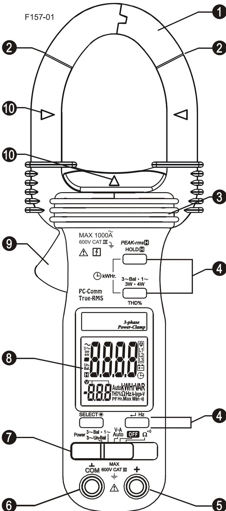
1) Garra alicate transformadora para captura do campo magnético da corrente AC
