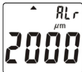
Figura 14 - Valor do limite máximo do alarme.
