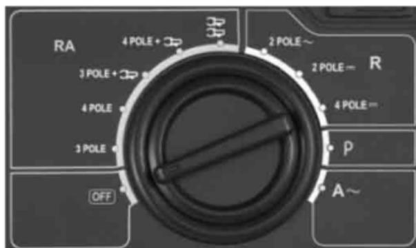
RA  $\square\square$  - Para medidas de resistência de aterramento com transformador de corrente e com transformador de tensão.
