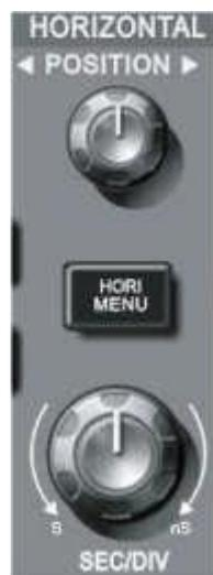
Figura 2-11 Interface do Sistema Horizontal
