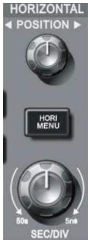
Figura 1-10 Área de Controle Horizontal no Painel Frontal
